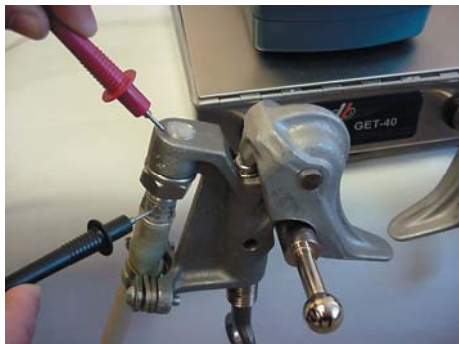
La sonde double pointe incluse permet d'effectuer des mesures précises sur des éléments en particulier (pinces, câbles, cosses, etc.)
