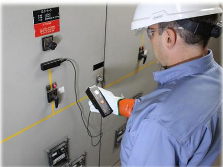
Sensor acústico de contacto para detección de descargas parciales en gabinetes metalclad
