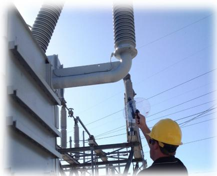
Capteur parabolique pour détection d'effet corona
