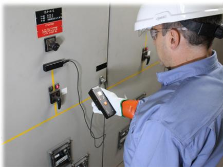
Capteur acoustique contact pour détection de décharge partielle de cabinets métalliques
