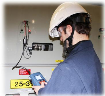
**Zwei-Phase Koppler im Einsatz an Schaltschrank mit XDP-II™ TE-Messsystem**
