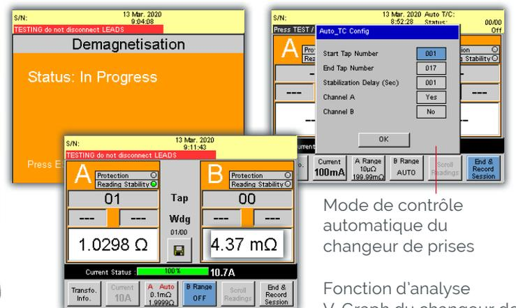
Mode de contrôle automatique du changeur de prises
